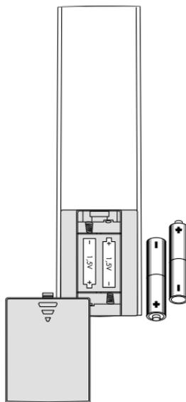
1. Zum Öffnen des Batteriefachs drücken Sie leicht auf den geriffelten Pfeil und schieben den Deckel nach unten auf.
